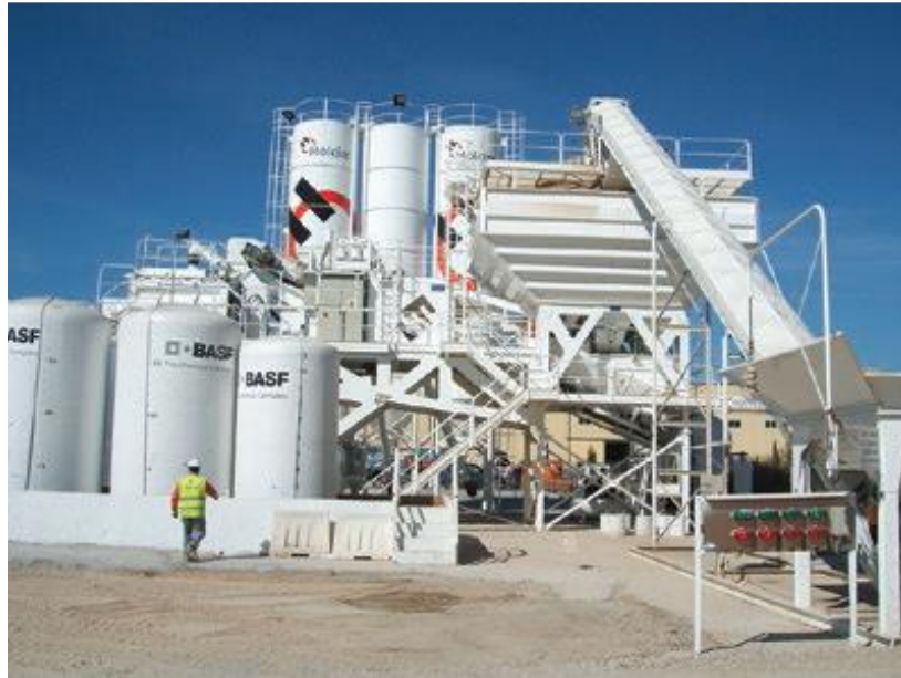
شکل ۵-۶ کارخانه مرکزی برای تولید بتن
