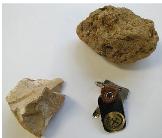
شکل ۴-۳ مواد اولیه آهکی و رسی مورد استفاده در تولید سیمان
