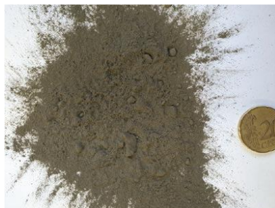
شکل ۴-۷ خاکستر بادی مورد استفاده در کارخانه سیمان
