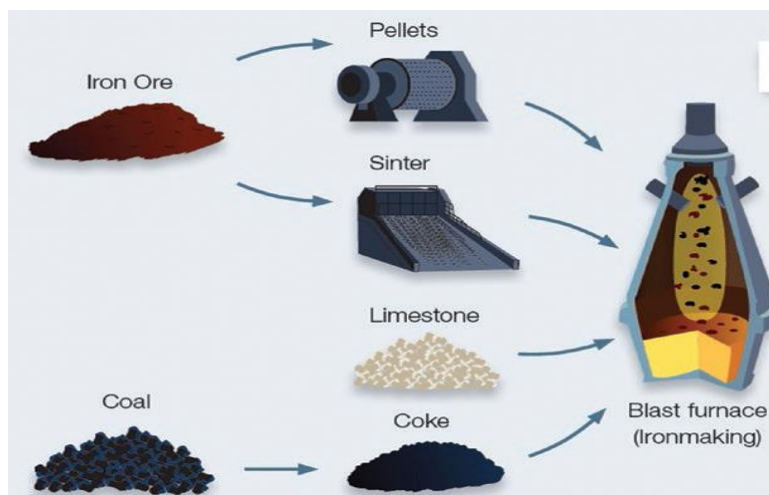
شکل ۲-۲ مسیر کوره بلند برای به دست آوردن آهن
