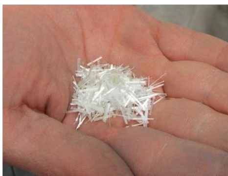
شکل ۵-۳ الیاف شیشه برای ملات
