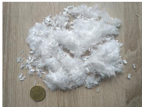
شکل ۶-۱۸ الیاف پلی پروپیلن
