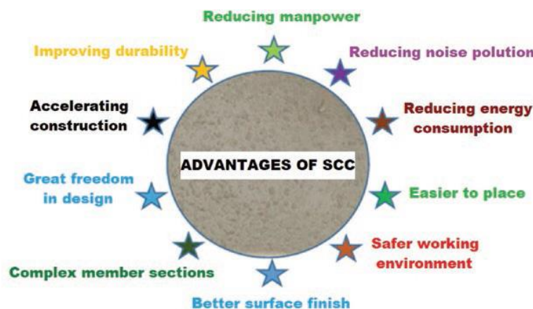
شکل ۱۹-۶ مزایای بتن خودتراکم در مقایسه با بتن معمولی ویر شده
