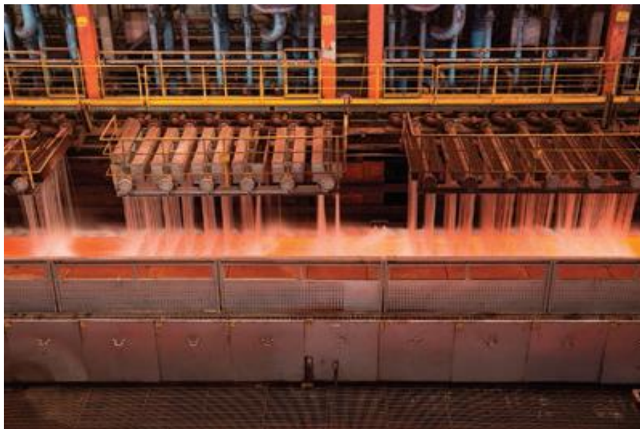
شکل ۲-۴ نورد گرم (فولاد داغ که با آب پاشیده می شود)
