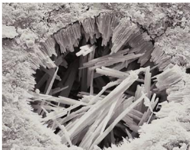
شکل ۶-۱۱ اترینگایت ثانویه سفید که در یک فضای خالی انباشته شده است؛ عرض میدان ۶۴ میکرومتر
