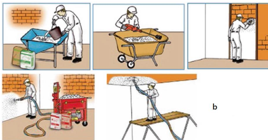
شکل ۸-۷ روش های اعمال اندود گچ: الف) دستی؛ ب) پاشش
