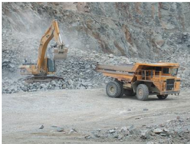
شکل ۳-۳ بارگیری مصالح سنگی در معدن سنگ خُرد شده برای مصالح سنگی
