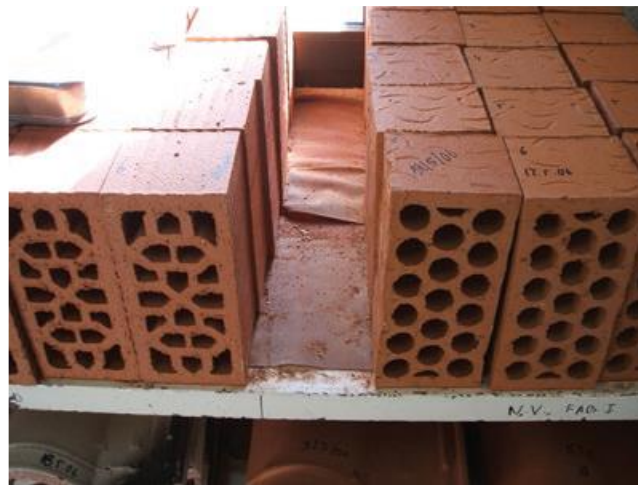
شکل ۹-۳ آجرهای سفالی استاندارد کلاسیک
