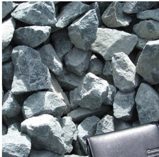
شکل ۶-۲ سنگدانه تیز گوشه
