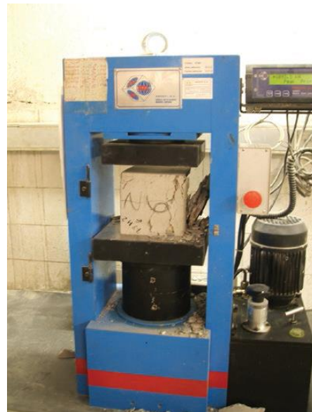
شکل ۳-۶ نمونه های بتن پس از گیرش و عمل آوری برای آزمایش مقاومت فشاری
