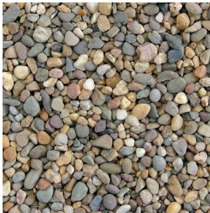
شکل ۳-۶ سنگدانه درشت با گرد شدگی مناسب
